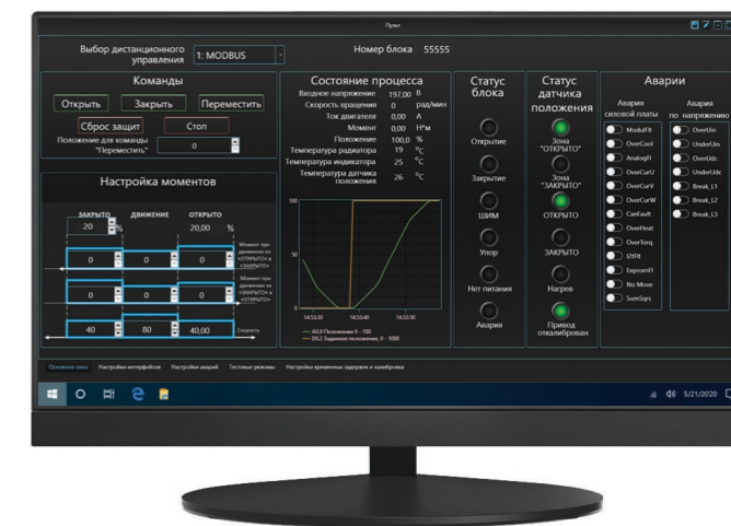
Пульт настройки и управления электроприводом арматуры
